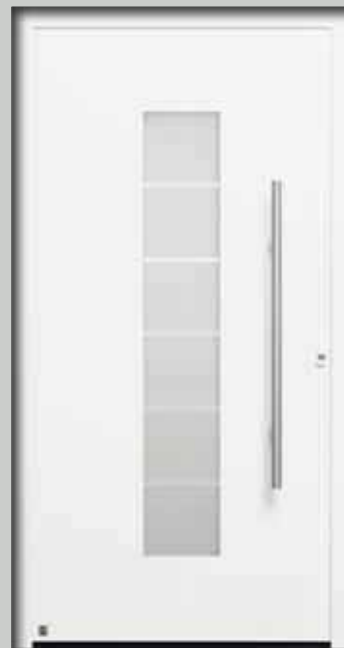
Motivo 504 Maniglia in acciaio inox HOE 500, vetro decorativo Float opaco con 5 strisce trasversali trasparenti, triplo vetro termico, valore U_D fino a 0,9 \text{ W}/(\text{m}^2\cdot\text{K})^*
