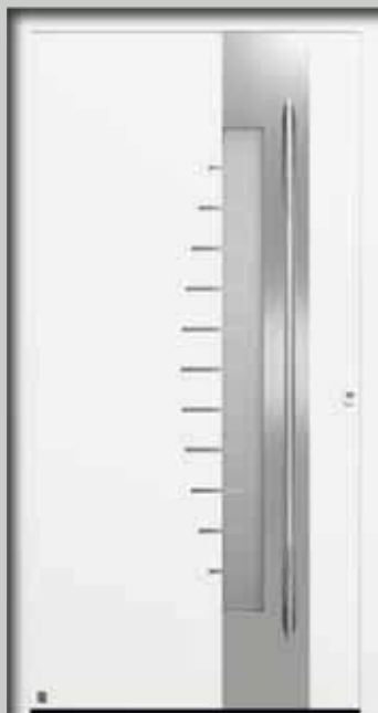
Motivo 559 Maniglia in acciaio inox HOE 200, decorazione in acciaio inox, esternamente vetro di sicurezza accoppiato trasparente con 11 strisce trasparenti, al centro Satinato, all'interno vetro di sicurezza accoppiato trasparente, triplo vetro termico, valore U_D fino a 0,9 \text{ W}/(\text{m}^2\cdot\text{K})^*
